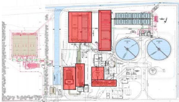
[Graphik 11: Kläranlage Ober-Roden 1974, bestehend aus Zulaufhebewerk, Sandfänge, Vorklärung, Belebung, Eindicker, Faulturm (rot hervorgehoben)]
