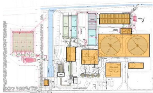
[Graphik 12: Kläranlage Ober-Roden 1999, neue Anlageteile bestehend aus Fäkalannahmestation, Sand-/Fettfang, Belebung, Nitrifikation, Nachklärbecken, Schlammwässerung, Gasbehälter (orange hervorgehoben)]
