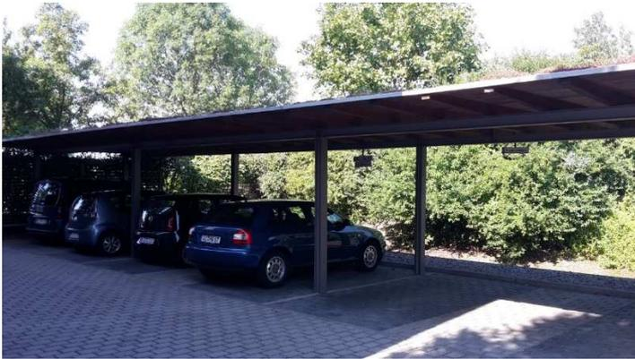
**Foto 2:** Beispielhafte Darstellung einer Stellplatzüberdachung mit extensiver Dachbegrünung. (Fotoaufnahme: ÖKOPLANA)
